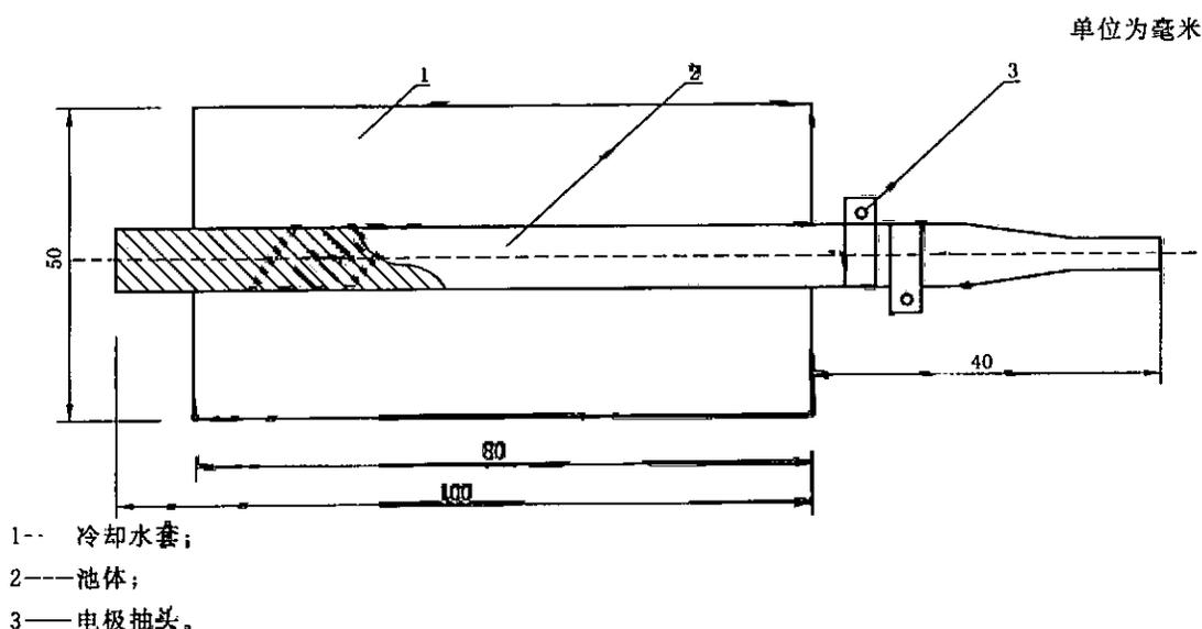
图 9 Pt-P<sub>2</sub>O<sub>5</sub> 电解池示意图
